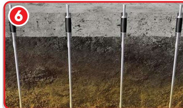
6 Densification de sol et traitement de fissures
